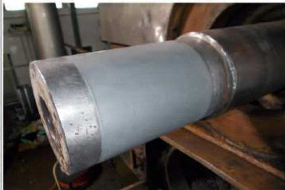
Восстановление посадочной шейки вала парового барабана
