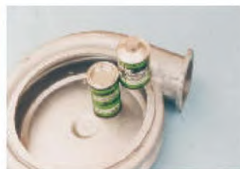
Устранение раковин на корпусе насоса
