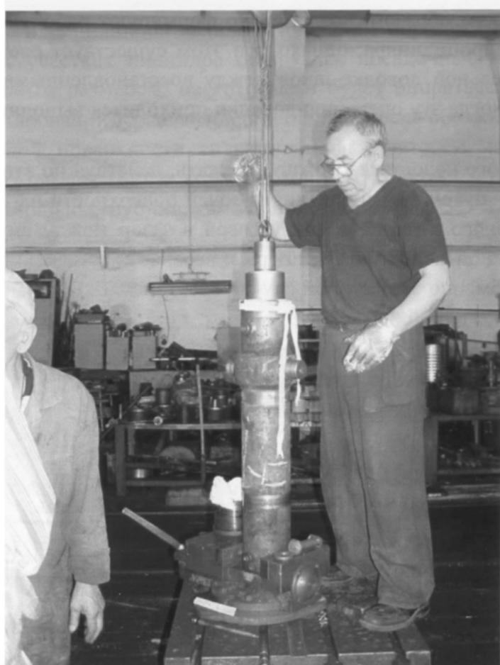
Рисунок 33 – Опускание шаблона с помощью крана в полость гидроцилиндра
