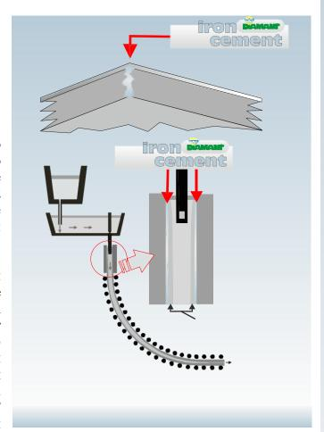
Подобным простым и надёжным способом можно устранить повреждения и изнашивания металлических частей кристаллизатора (со стороны охлаждающей воды) с помощью медного пластика "DIAMANT".
