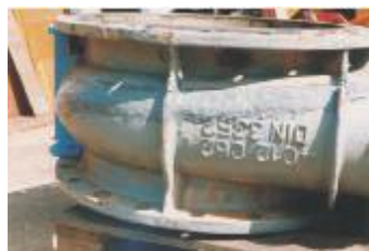
Холодная заварка корпуса насоса
