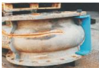
Холодная заварка корпуса насоса
